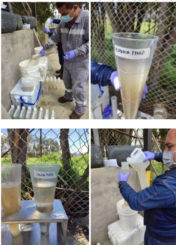
Agua residual de entrada y salida en nuestra PTAR
